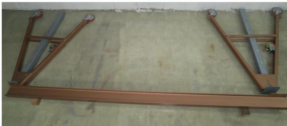
3. Нанести на поверхность фланца стойки тонкий слой консистентной смазки. Соединить балку крана и стоки, совместив направляющий болт стойки с отверстием в балке крана, установить и затянуть два болта, расположенных по диагонали. Ослабить гайки этих болтов на один оборот.
