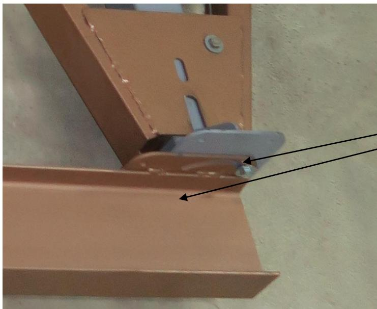
4. Поднимая балку МПУ вверх и упирая колеса в стену поставить кран в вертикальное положение. Удерживая кран в вертикальном положении, повернуть стойки крана на 90 градусов.
