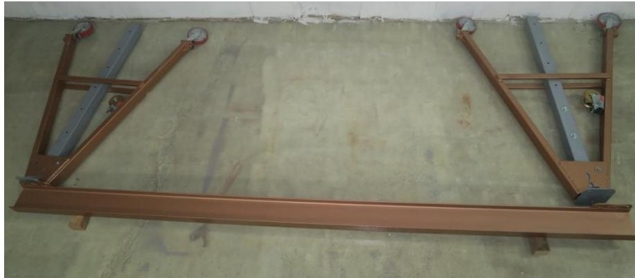
3. Нанести на поверхность фланца стойки тонкий слой консистентной смазки. Соединить балку крана и стойки, совместив направляющий болт стойки с отверстием в балке крана, установить и затянуть два болта, расположенных по диагонали. Ослабить гайки этих болтов на один оборот.
