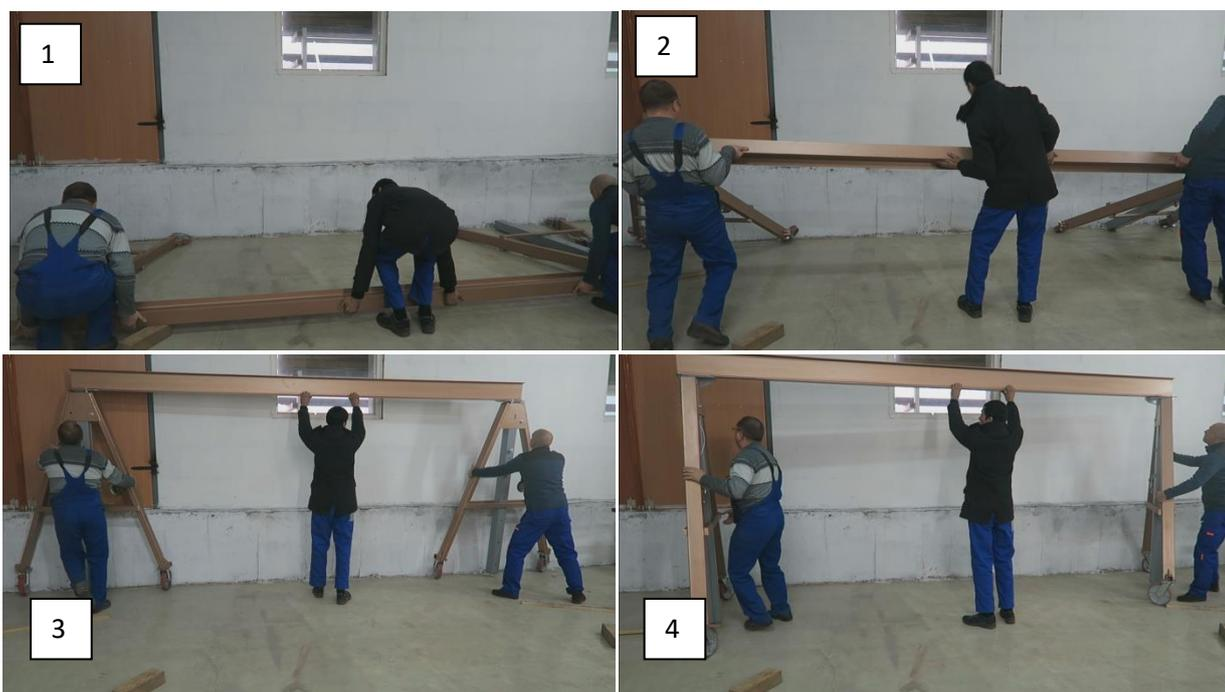
5. Установить и затянуть все болты крепления верхней балки мобильного перегрузочного устройства.
