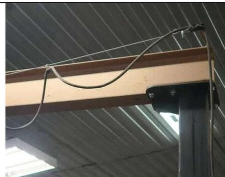
Двойная балка, (уменьшение строительной высоты тали). Размещение каретки тали на двойной балке, а грузоподъемной тали внутри двойной балки, позволяет существенно увеличить высоту подъема. [Подробнее.](#)
