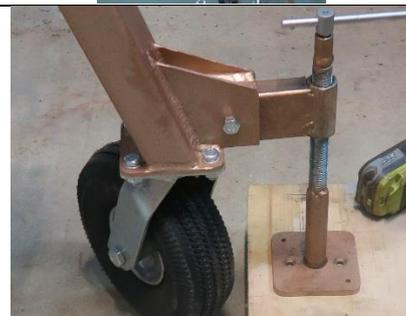
Усиленные колеса. Для крана грузоподъемностью 1-2 тонны, возможна замена колес на колеса от крана большей грузоподъемностью. [Подробнее.](#)
